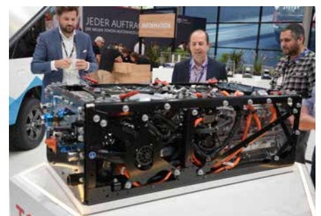
Toyotas brenselcelle-modul som produserer elektrisitet gjennom en kjemisk reaksjon mellom hydrogen og oksygen, og som kan kombineres med ulike typer motor-drivstoff-løsninger.
