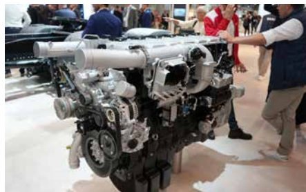
MAN H4576, hydrogendrevet forbrenningsmotor med null utslipp, men ellers 90 prosent lik en dieselmotor.
