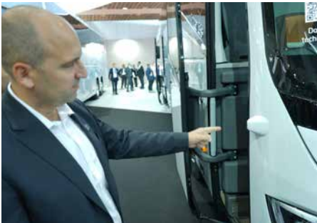
En representant for spanske Irizar viser fram et snertent kamera som overvåker blindsonen mot syklister og fotgjengere.
