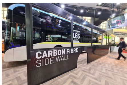
Overbygning av kompositt med lettere vekt er noe av det nye hos bussprodusentene, etter sigende sikrere enn stål og aluminium.
